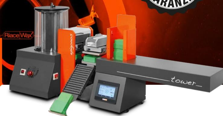
Iniettore con **caricatore stampi verticale**, completamente controllabile da **touch screen** che consente di realizzare un processo altamente automatizzato, facile e veloce.
