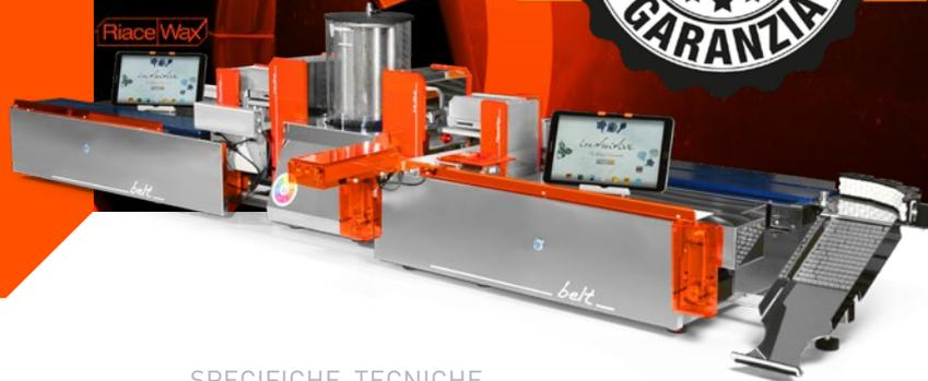
Completamente controllabile da **tablet**, permette di **quadruplicare la produzione** giornaliera standard, realizzando **fino a 9600 pezzi in 8 ore lavorative con due operatori**, iniettando stampi anche di dimensioni fra loro molto differenti e riducendo il numero di cere difettate.
